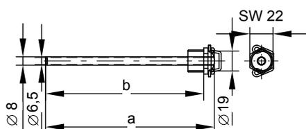
При работе с гелиоустановкой мы рекомендуем установить датчик температуры емкостного водонагревателя в обратную магистраль греющего контура (см. стр. 7). Для этого в комплекте поставки имеется свертный уголок с погружной гильзой.
